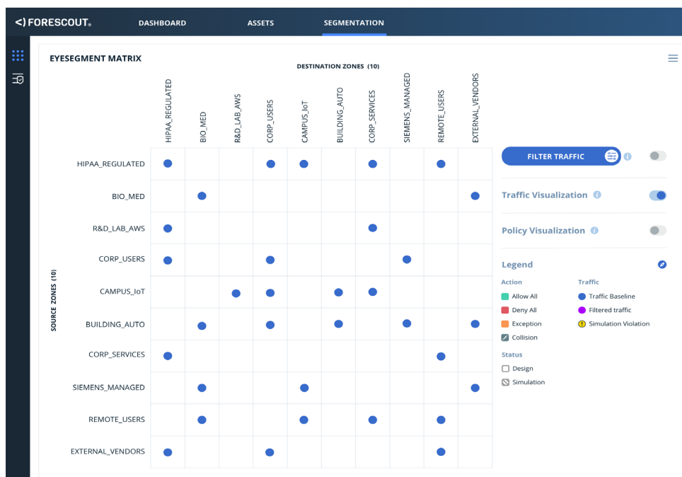
Figura 2: Griglia della connettività di eyeSegment con i flussi logici del traffico aziendale.
