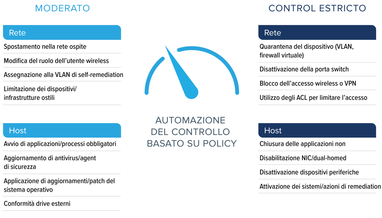
Figura 1. Applicazione delle policy sulla rete e sugli endpoint, aumentando l'automazione nel tempo.
